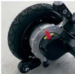
Automatische elektromagnetische rem en vrijloop functie om te duwen.
